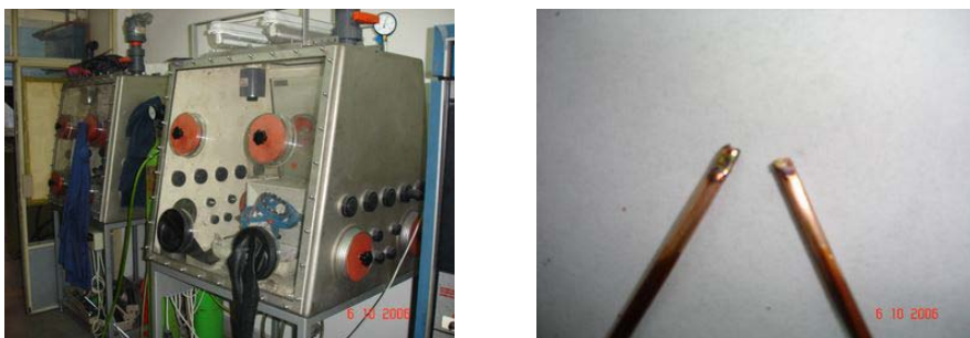
Slika 1. Boks u kome je simuliran sekundarni kratki spoj i izgled prespojenih provodnika
